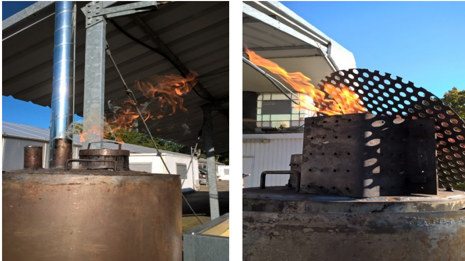
Abbildung 1: Gasverbrennung aus der Pyrolysekammer [eigene Darstellung]
