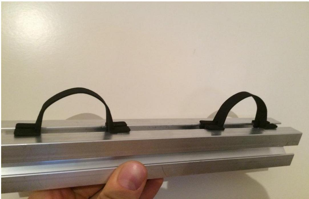
Einspannklipps für den Entzugswärmetauscher, es müssen keine Schellen mehr ins Metall gebohrt werden um den Entzugswärmetauscher zu befestigen.
