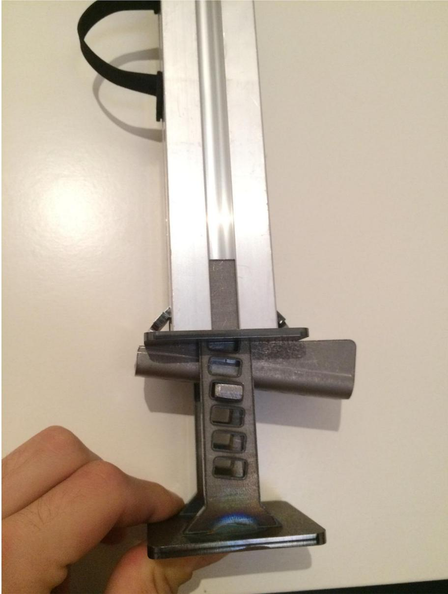
Einspannkonsolle: Durch diese wird die Schiene zwischen Bodenplatte und Decke eingespannt. Somit muss weder in Boden noch in Decke gebohrt werden. Es werden eventuelle Sprengwirkungen vom Eis an der Behältergeometrie verhindert.
