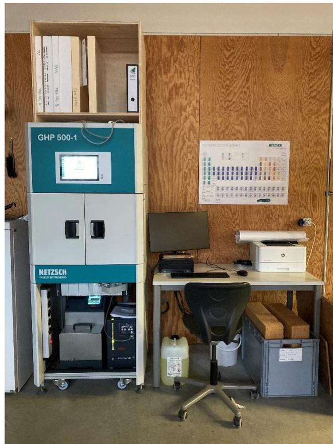
Abb. 23: Plattengerät zur Bestimmung der Leitfähigkeit (Foto © C. Zwanger)
