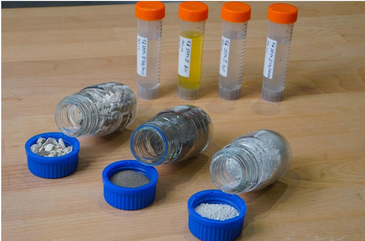
Abb. 6: Ascheproben aus einem Holz-Heizkraftwerk (vorne) und Waschwässer, in denen sich die extrahierten Elemente befinden (Foto © S. Voth)
