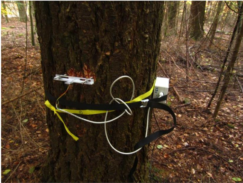
Abb. 17: Eine ca. einhundertjährige Douglasie am Standort Limmersdorfer Forst in Nordbayern mit automatischem Radial-Dendrometer und Kambialtemperatursensor (links am Stamm) sowie einem Datenlogger (rechts); (Foto © V. Horna).
