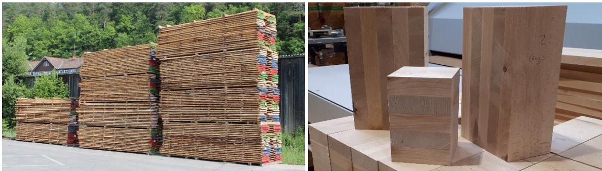
Abb. 16: Zur Holz Trocknung gestapeltes Projektholz (rechts) und gefertigte Brettsperrholz-Prüfkörper für Brandversuche an der HS Magdeburg-Stendal (links)
