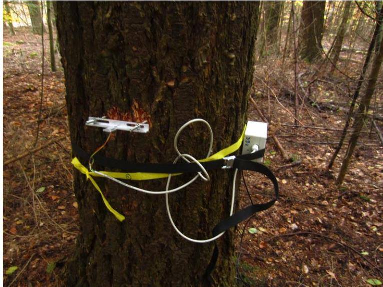
Abb. 19: Eine ca. einhundertjährige Douglasie am Standort in Nordbayern (Limmersdorfer Forst) mit automatischem Radial-Dendrometer und Kambialtemperatursensor (links am Stamm) sowie einem Datenlogger (rechts).
