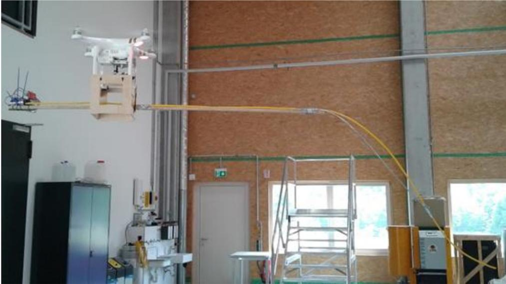
Abb. 7: Fliegender Prototyp einer kommerziell erhältlichen Drohne mit angebaurem VOC-Sampling-System für die Beprobung des Kronenraumes
