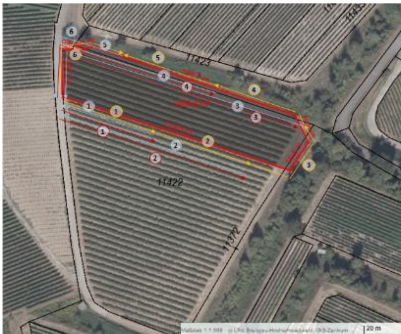
Abbildung 36: Schematische Darstellung der Abfolge eines Zaunbauprozesses am Standort Blankenhornsberg anhand der Nummerierung mit farblicher Unterscheidung der Arbeitsvorgänge. Die zugehörigen Zeitwerte sind in Tabelle 8 aufgeführt.
