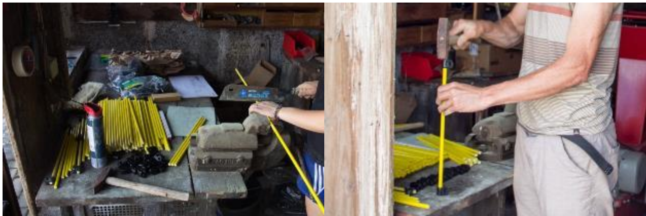
Abbildung 76: Herstellung der GFK-Litzenhalterung. Bild links: Ablängen der Pfähle. Bild rechts: Aufschlagen der Isolatoren, das Abrunden der Enden und etwas Silikonspray erleichtern diesen Schritt. Fotos: Jakob Hörl.
