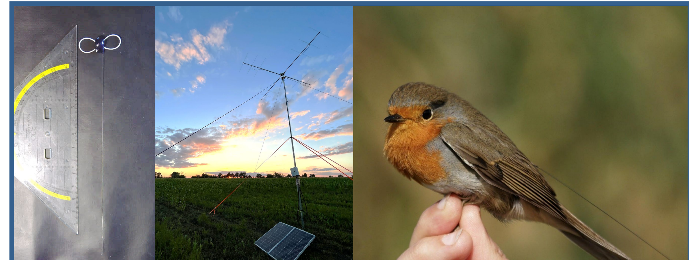
Abb. 5: Links: eine Radiosender mit Tragegurt. Mitte: eine Empfangsstation mit vier Antennen. Rechts: Rotkehlchen mit Radiosender © L. Redetzke
