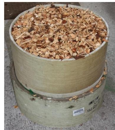
**Abbildung 50:** Homogenisierte Einzelprobe von 121 l (FOCKE, 2013)
