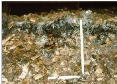
**Abbildung 15:** Verpilzte Kondensationszone bei Haufentrocknung (WITTKOPF, 2009, S. 2)
