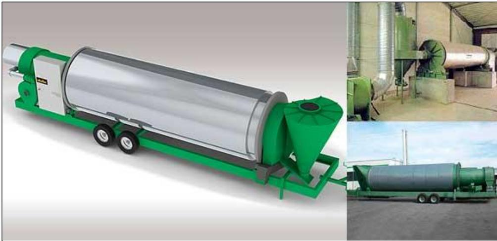
**Abbildung 31:** Trommeltrockner stationär und mobil
