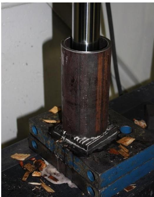
**Abbildung 47:** Statischer Pressversuch mit mechanischer Presse auf geriffelter Oberfläche (FOCKE, 2012)
