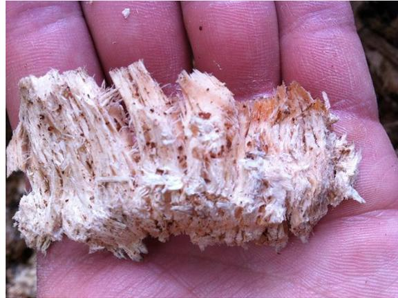
**Abbildung 65:** Hackgutpartikel nach der Pressung
