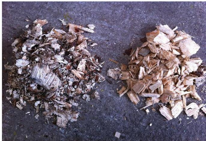
**Abbildung 89:** Vergleich von gepresste (links) und ungespressten Hackgutpartikel (rechts)
