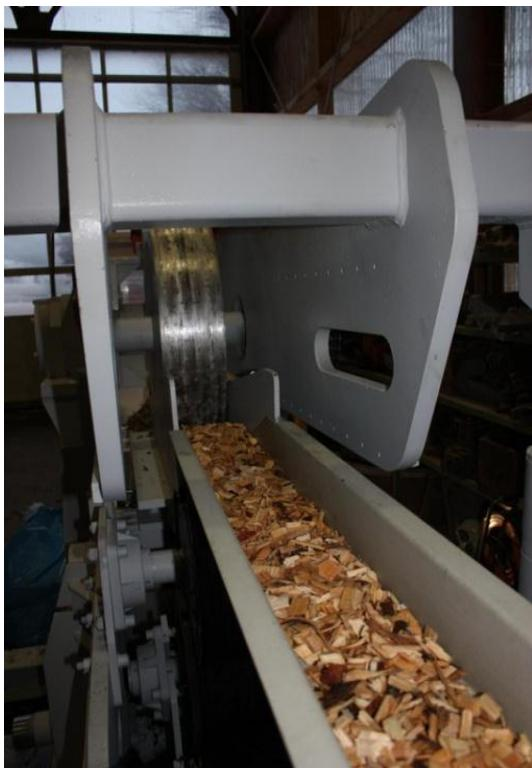
**Abbildung 51:** Durchführung eines Pressdurchganges, Materialzufuhr in die Presszone (FOCKE, 2013)
