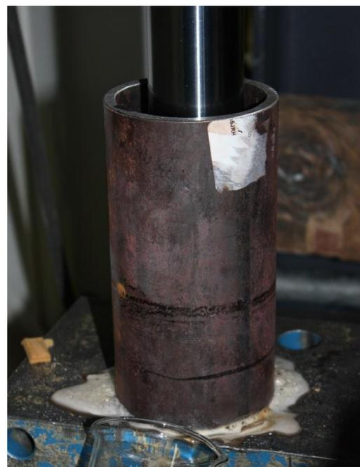
**Abbildung 46:** Statischer Pressversuch mit mechanischer Presse auf glatter Oberfläche (FOCKE, 2012)
