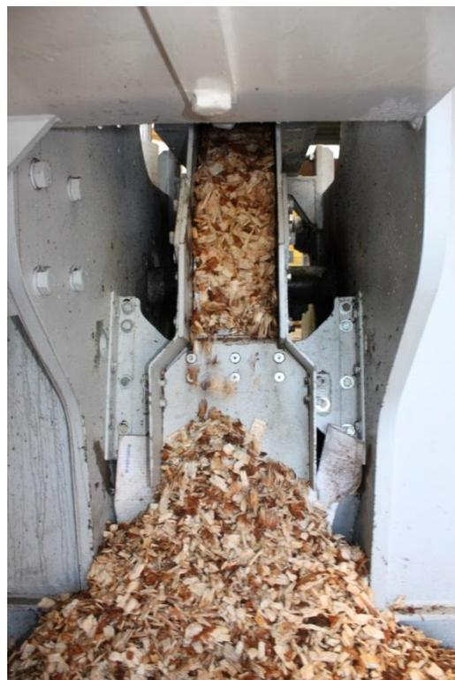
**Abbildung 52:** Materialauswurf nach der Pressung in der Presszone (FOCKE, 2013)
