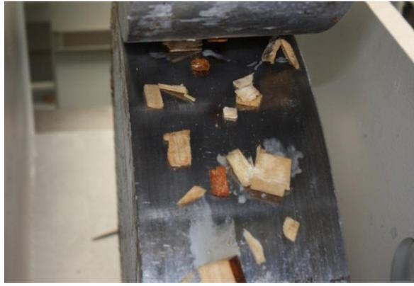
**Abbildung 44:** Hackgut nach Verlassen der Presszone (FOCKE, 2012)
