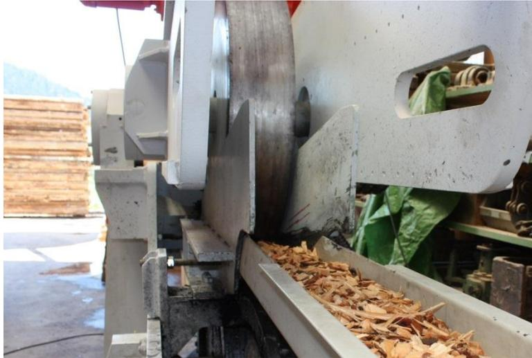
**Abbildung 49:** Zuführung des Hackgutes über die Vibrorinne auf die durchgehende Plattenkette (FOCKE, 2013)
