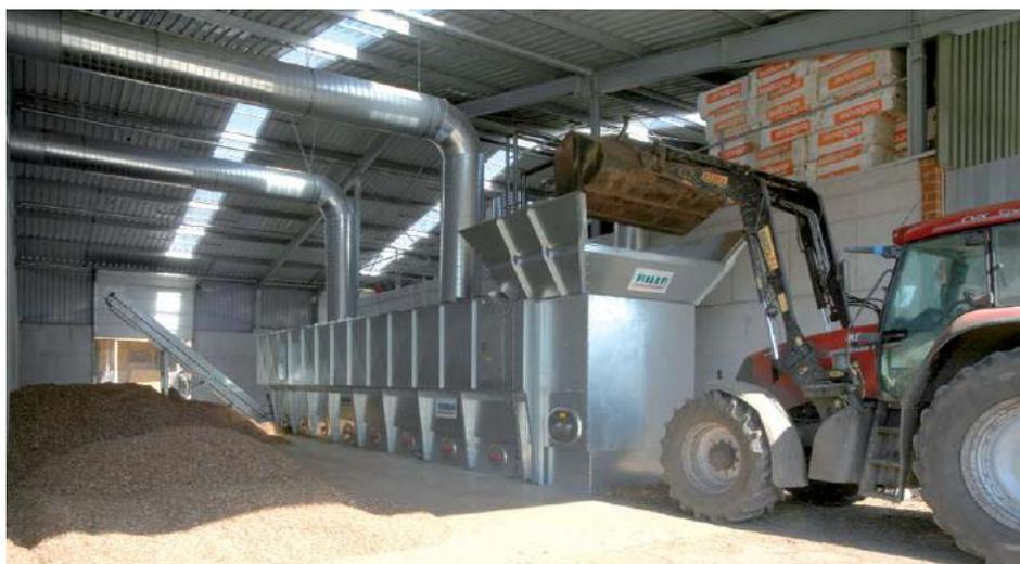
**Abbildung 27:** Schubwendetrockner im Betrieb (Werkbild Fa. RIELA)
