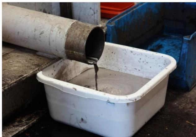
**Abbildung 53:** Ablauf des Presswassers im Vorversuch (FOCKE, 2013)
