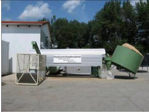
**Abbildung 34:** Eberl-Hackschnitzeltrockner ([www.eberl-trocknungsanlagen.de](http://www.eberl-trocknungsanlagen.de))
