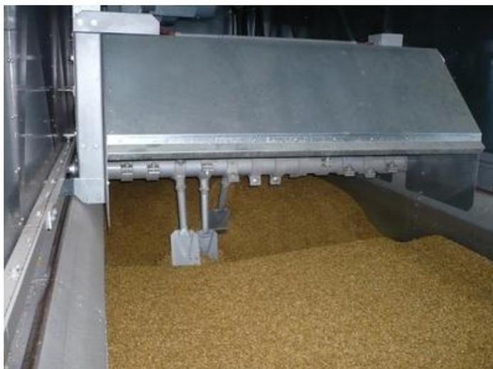
**Abbildung 28:** Schubwendetrockner mit im Einsatz befindlichem Wendewerk (<http://www.stela-drying-technology.de/de/produkte/schubwendetrockner/>)
