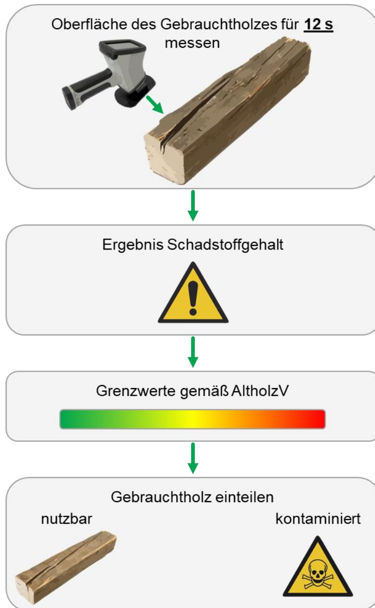
Abbildung 1: Ermittlung möglicher Schadstoffe anhand von Röntgenfluoreszenzanalyse.
