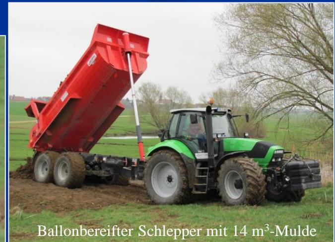
Ballonbereifter Schlepper mit 14 m<sup>3</sup>-Mulde
