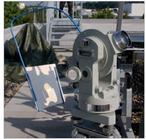
Abb. 4 : Theodolit mit Schablone und Halterung
